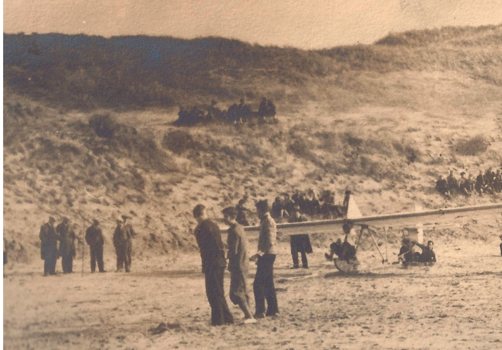
Gereed voor de start. Drie man aan het ene einde van de rubberkabel, twee die de staart van het zweefvliegtuig vasthouden. Bron: fotoalbum van John en Ben Fukken.
