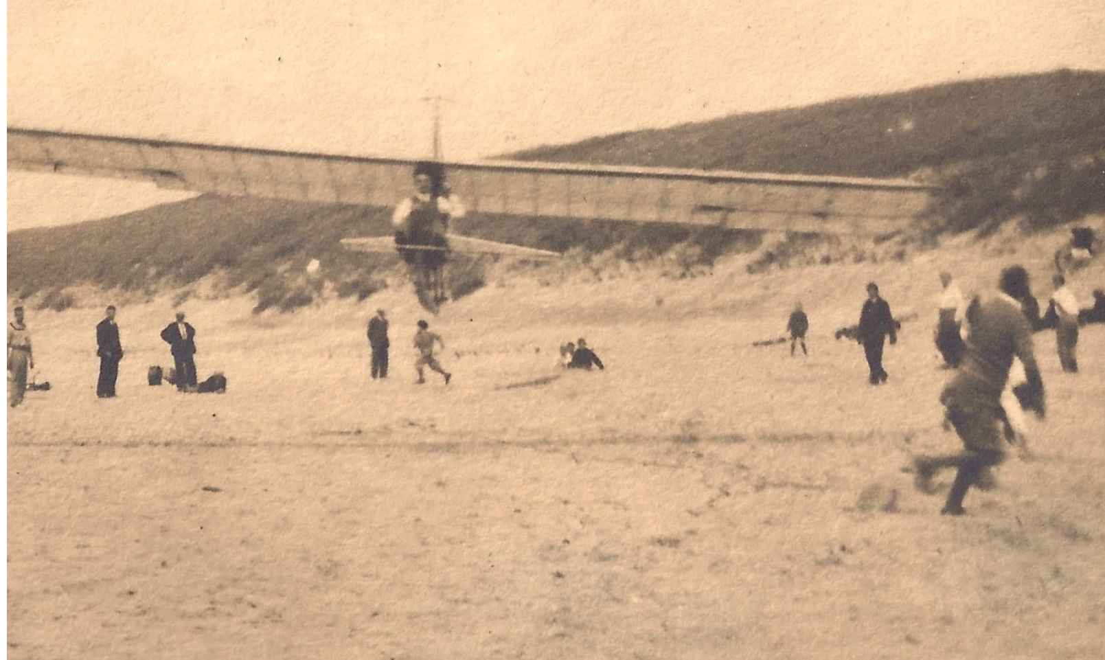
Geslaagde start. Let op de personen rechts op de foto die een einde van de rubberkabel hebben uitgetrokken. Op het commando 'los' is de staart losgelaten en schiet het vliegtuig vooruit, de lucht in. Bron: fotoalbum van John en Ben Fukken.
